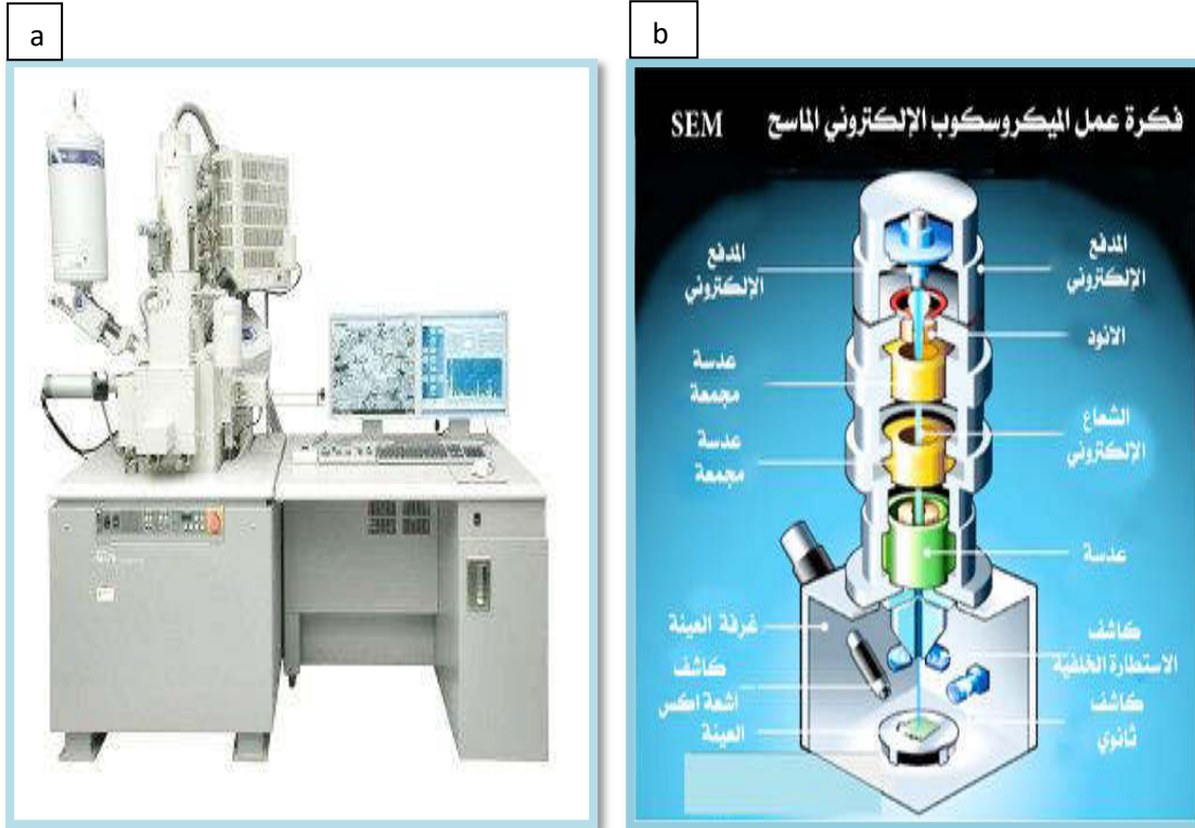
شكل (3 - 11): a- صورة للجهاز المجهر الإلكتروني الماسح، b- شكل عرضي للمجهر الإلكتروني الماسح (FE-SEM).
