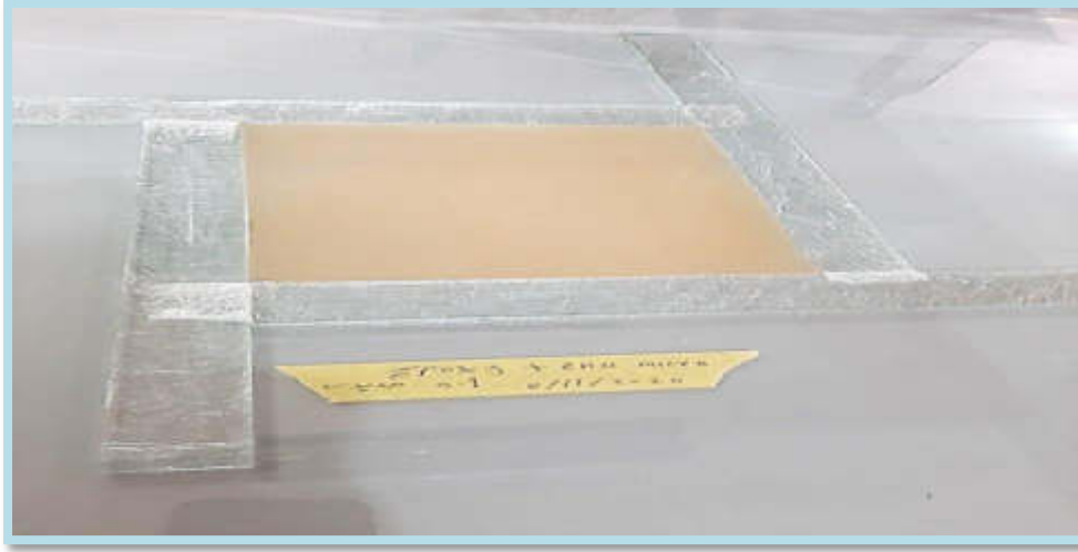
شكل (3-3): صورة القالب المستخدم في عمل العينات.
